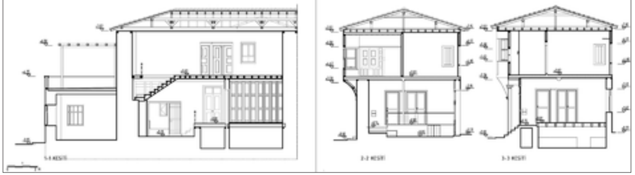
Şekil 16: Restorasyon enine ve boyuna kesitler.
