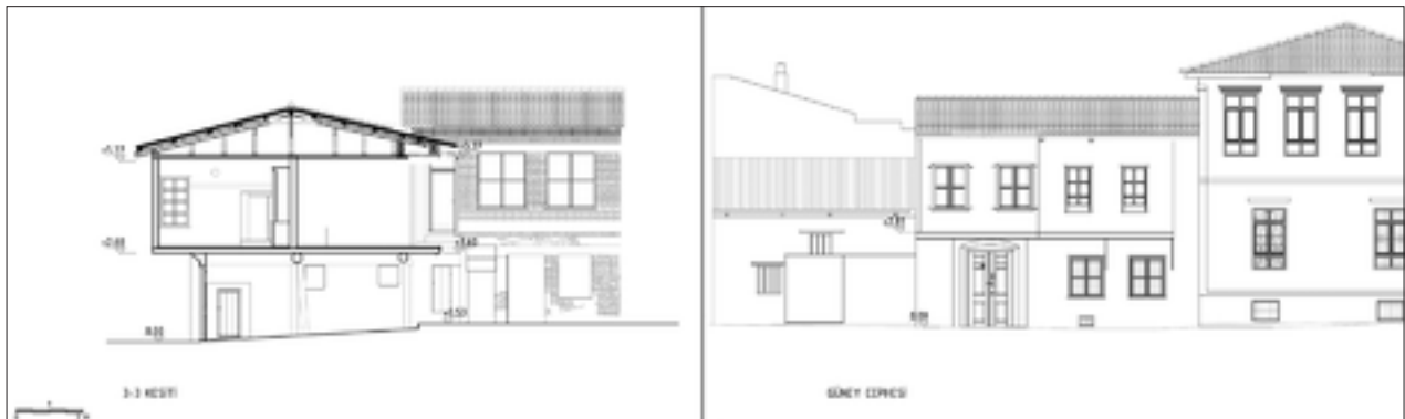
Şekil 21: Restitüsyon, 1950 ve sonrası, kesit ve ön cephe.
