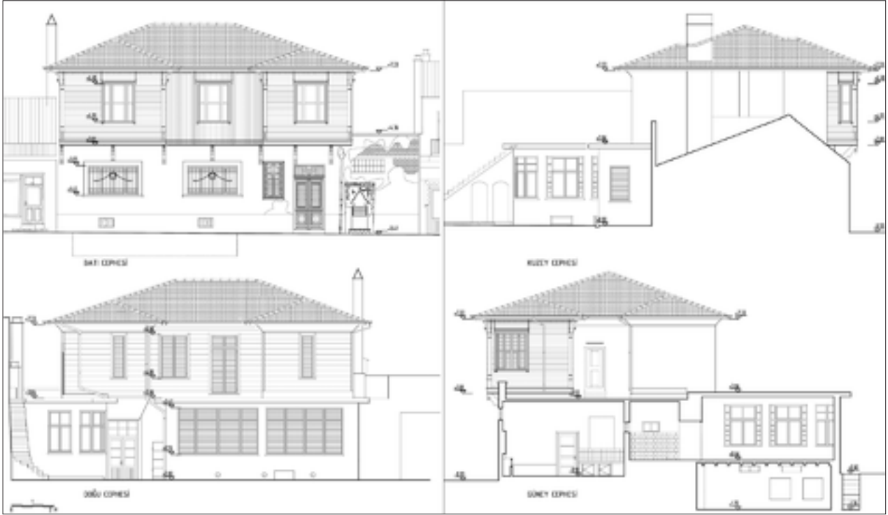
Şekil 8: Rölöve ön ve arka cepheler.
