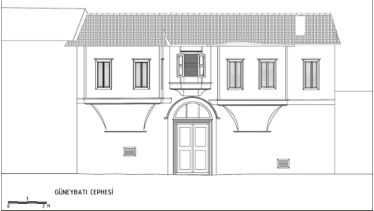
Şekil 20: Restorasyon güneybatı (163. Sokak) cephesi.
