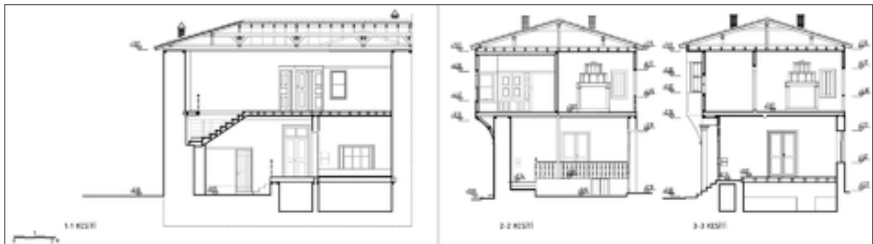
Şekil 9: 1. Dönem restitüsyonu enine ve boyuna kesitler.
