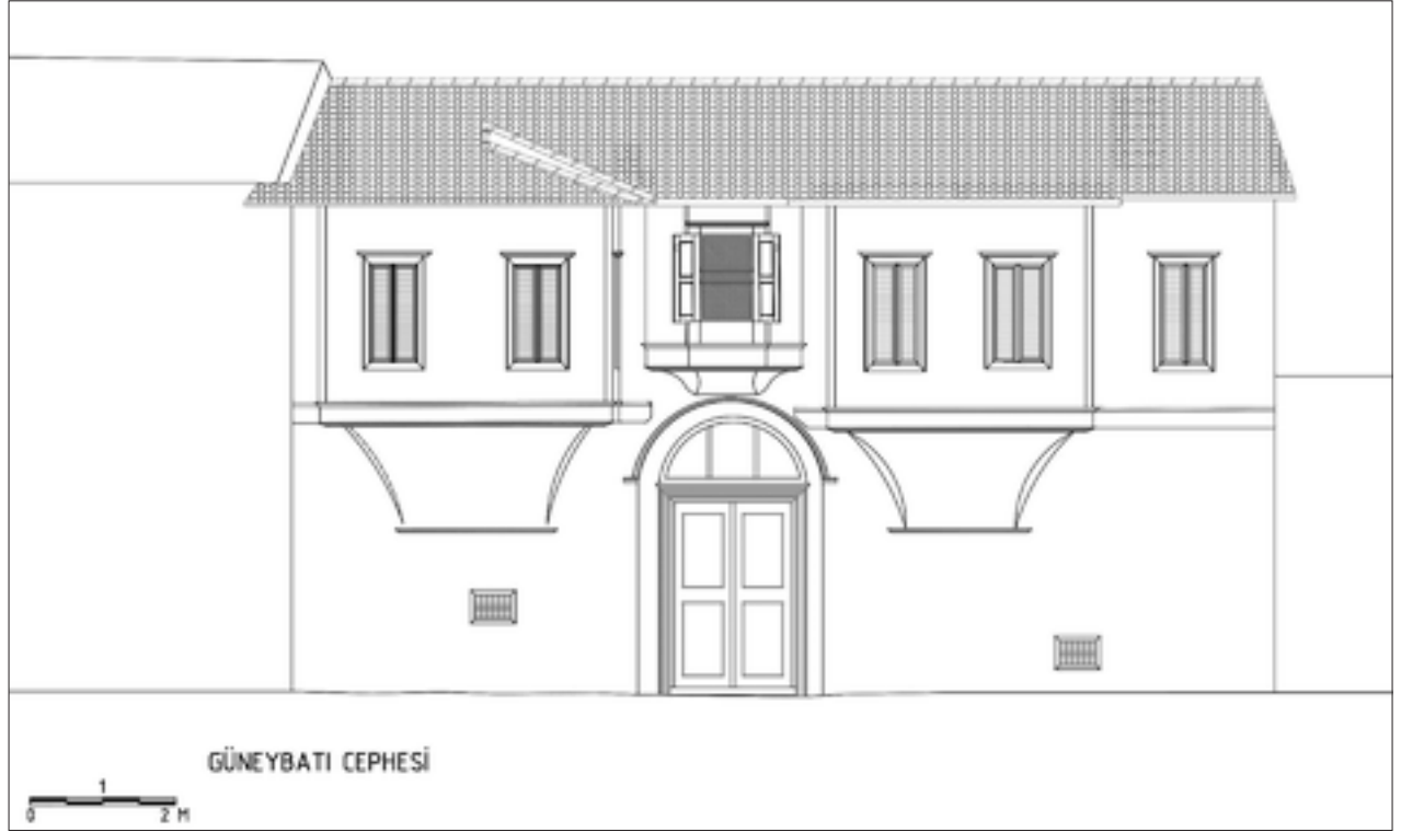
Şekil 17: I. Dönem restitüsyonu güneybatı (163. Sokak) cephesi.
