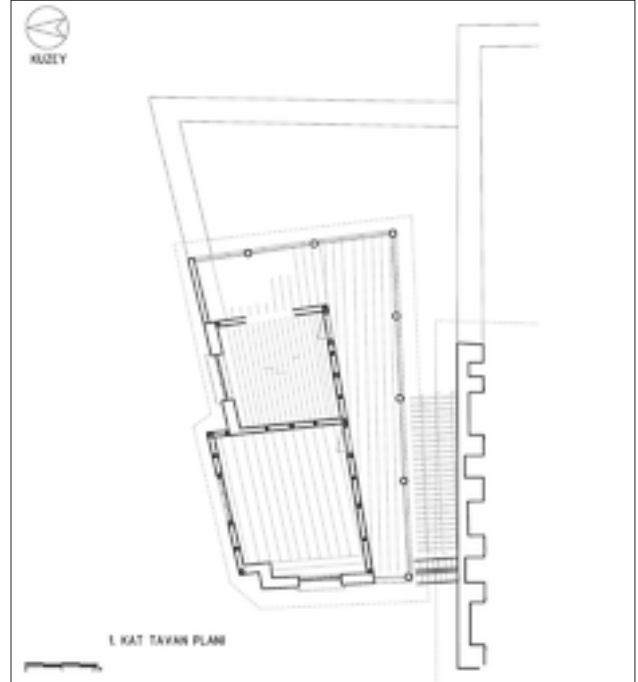
Şekil 15: Birinci kat tavan planı restitüsyon önerisi.
