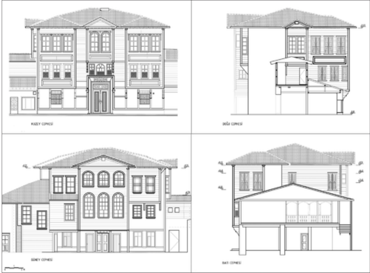
Şekil 17: Kuzey, doğu, güney ve batı cepheleri restitüsyon önerisi.
