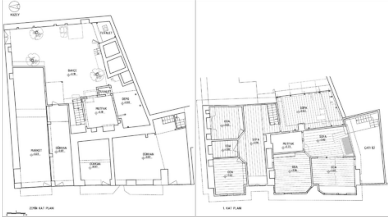
Şekil 2: Rölöve alt ve üst kat planları.
