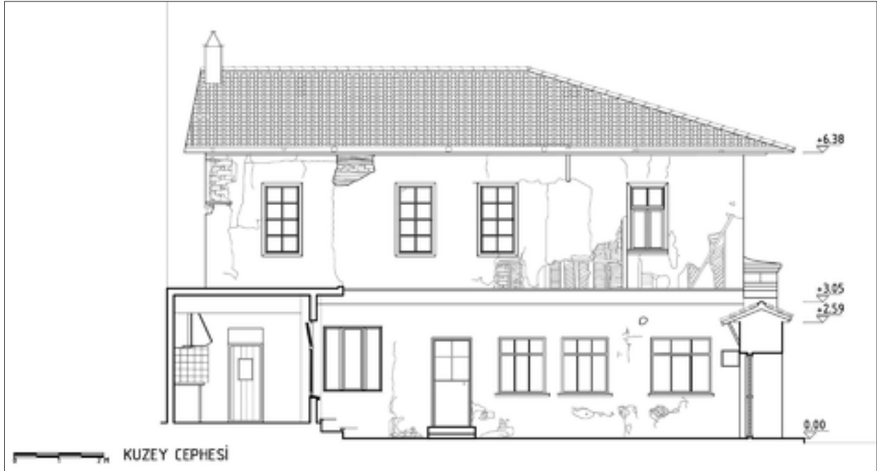
Şekil 8: Avlu cephesi rölövesi.
