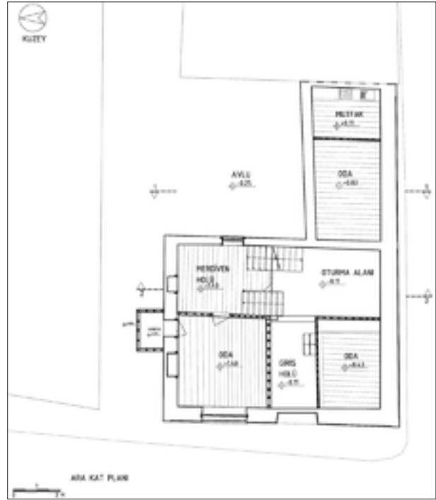
Şekil 20: Restorasyon kat planları - ara kat planı.
