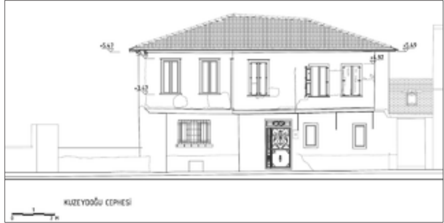
Şekil 8: Rölöve ön (doğu) cephe.
