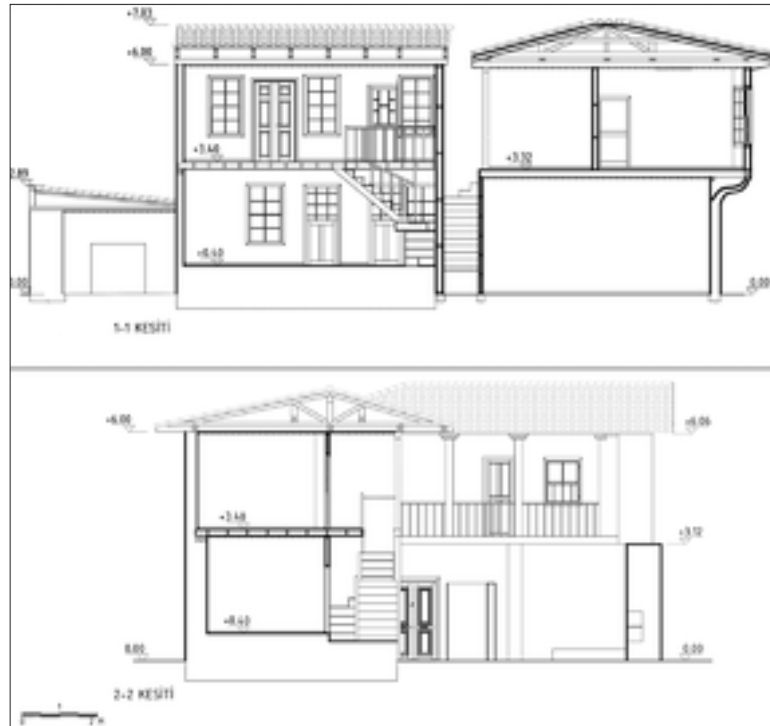
Şekil 12: İkinci dönem restitüsyonu enine ve boyuna kesit.
