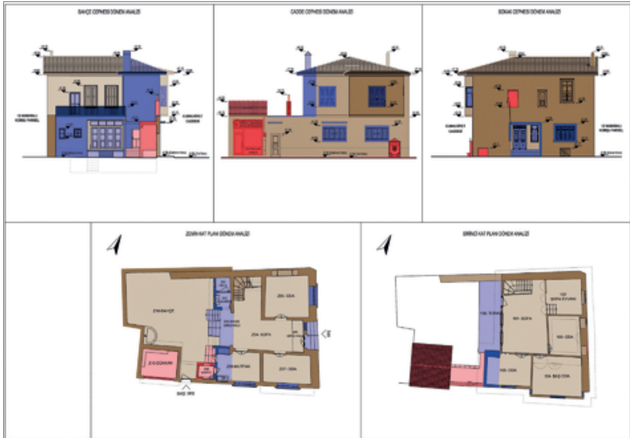
Şekil 17: Kat planları ve cephelerin dönemsel analizi.
