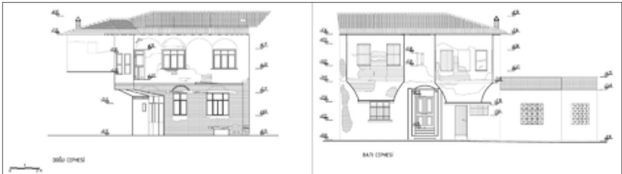
Şekil 5: Rölöve ön ve arka cephe.
