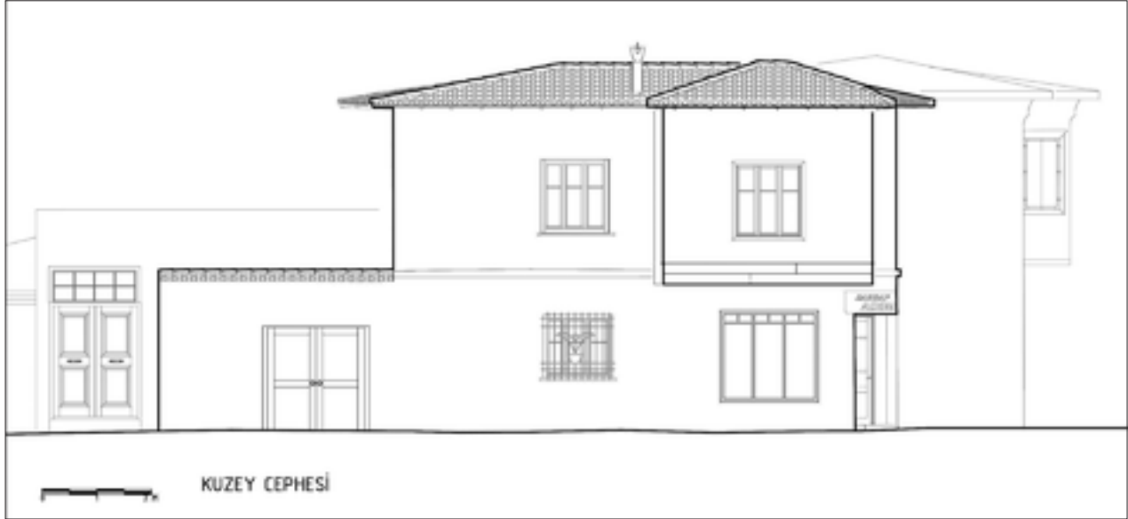
Şekil 16: Kuzey cephesi restitüsyon önerisi.
