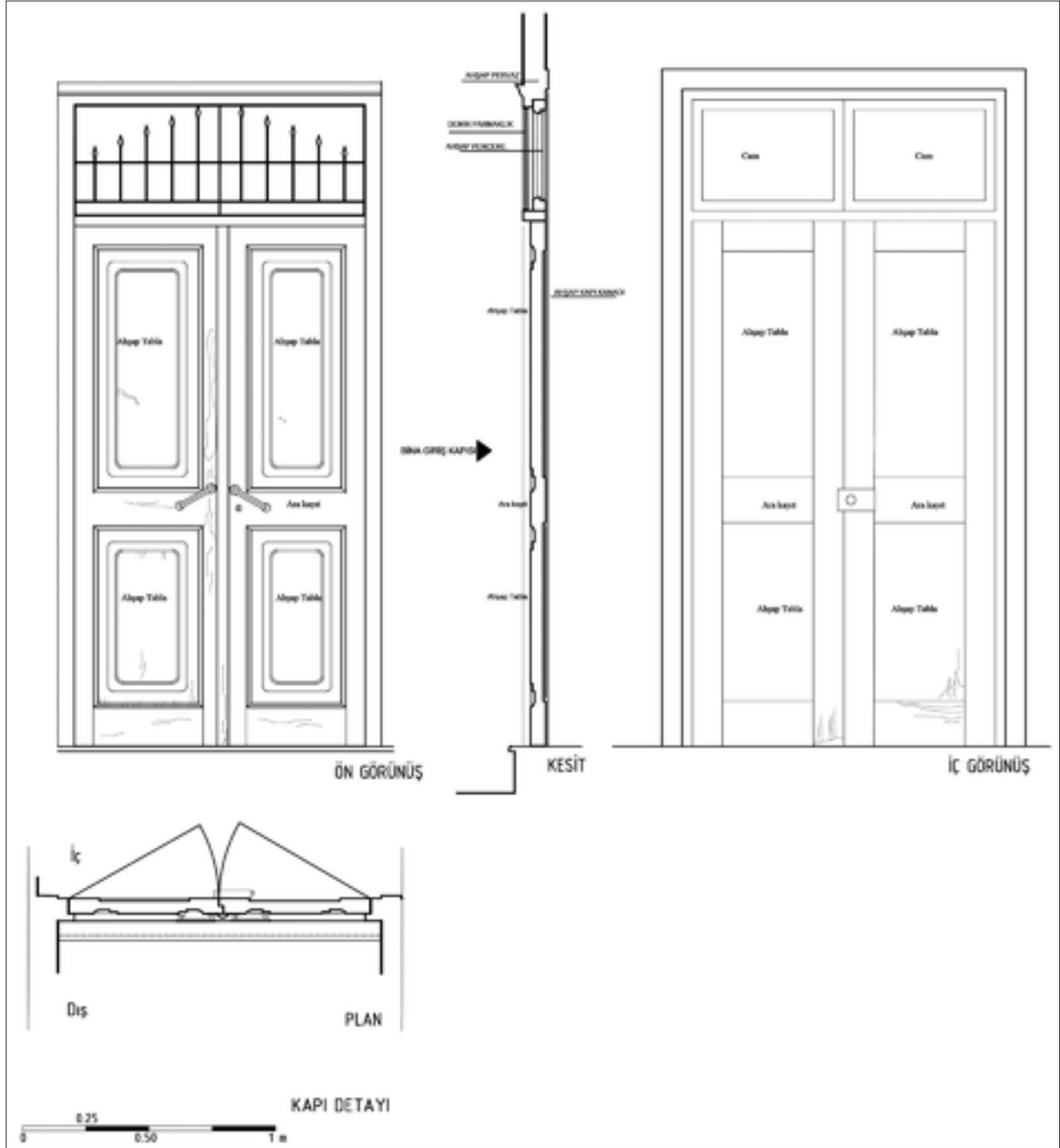
Şekil 6: Özgün yapı elemanı detayları.
