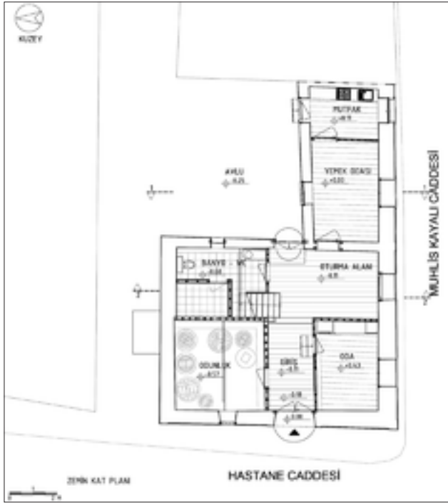
Şekil 19: Restorasyon kat planları - zemin kat planı.
