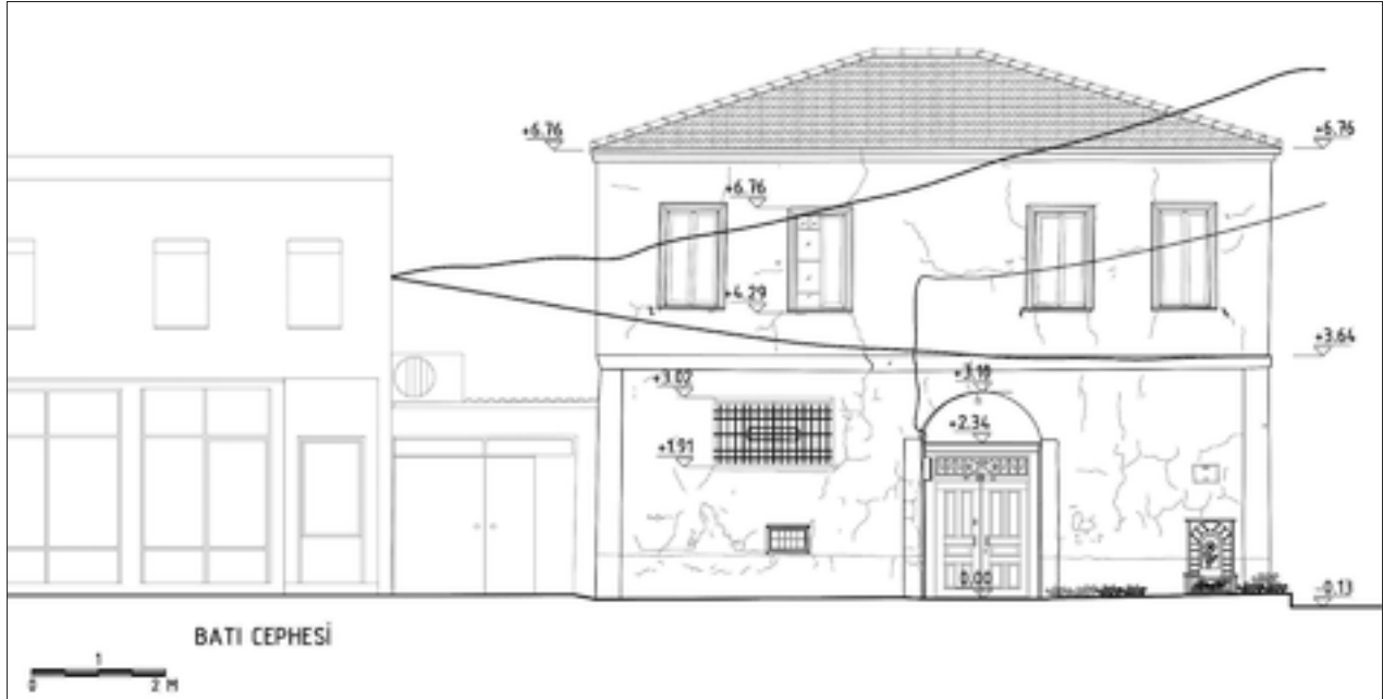
Şekil 10: Rölöve, ön cephe - Hastane Caddesi görünüşü.
