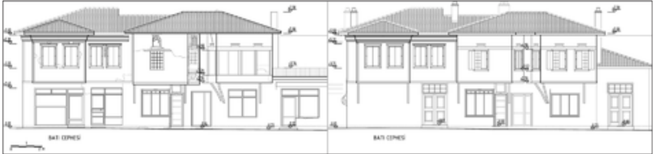
Şekil 20: Ön cephe rölövesi (solda) ve ikinci dönem restitüsyonu (sağda).
