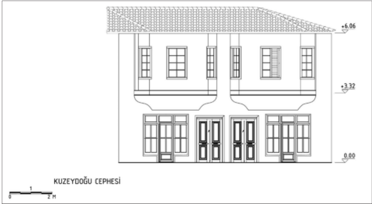
Şekil 13: İkinci dönem restitüsyonu giriş cephesi.
