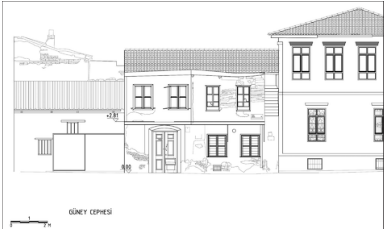
Şekil 8: Rölöve, ön cephe.
