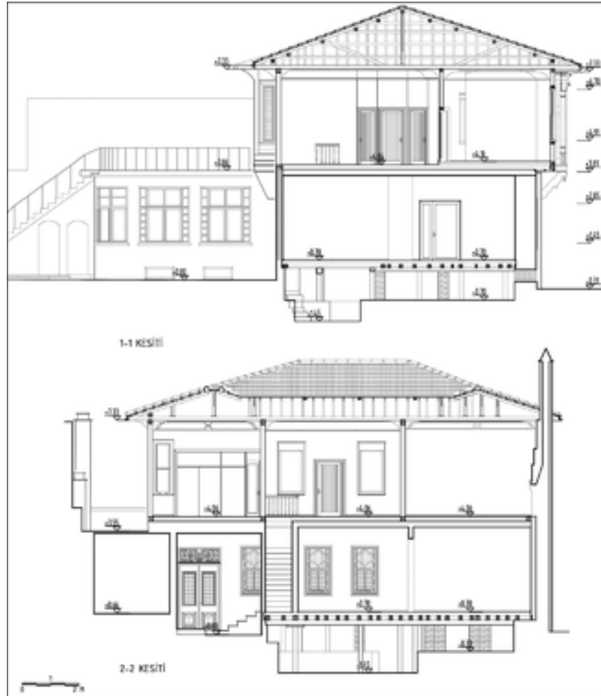
Şekil 17: Restorasyon enine ve boyuna kesit.
