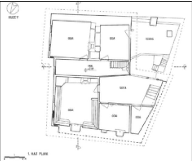
Şekil 4: Rölöve birinci kat planı.
