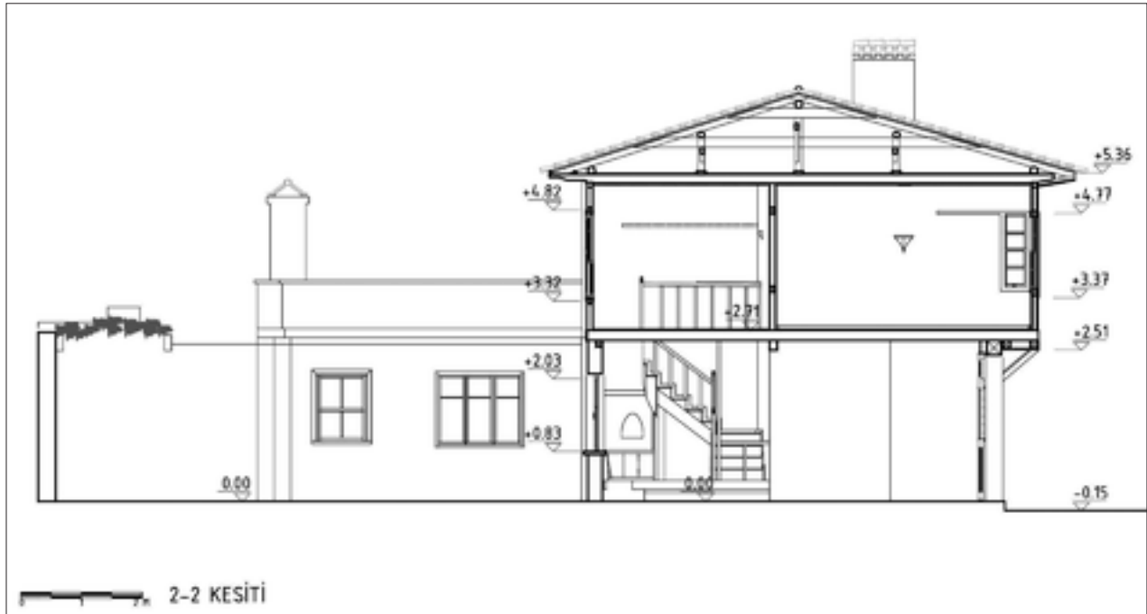
Şekil 12: Restorasyon 2-2 kesiti önerisi.
