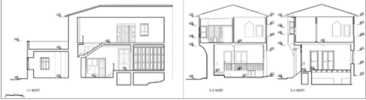
Şekil 4: Rölöve enine ve boyuna kesitler.
