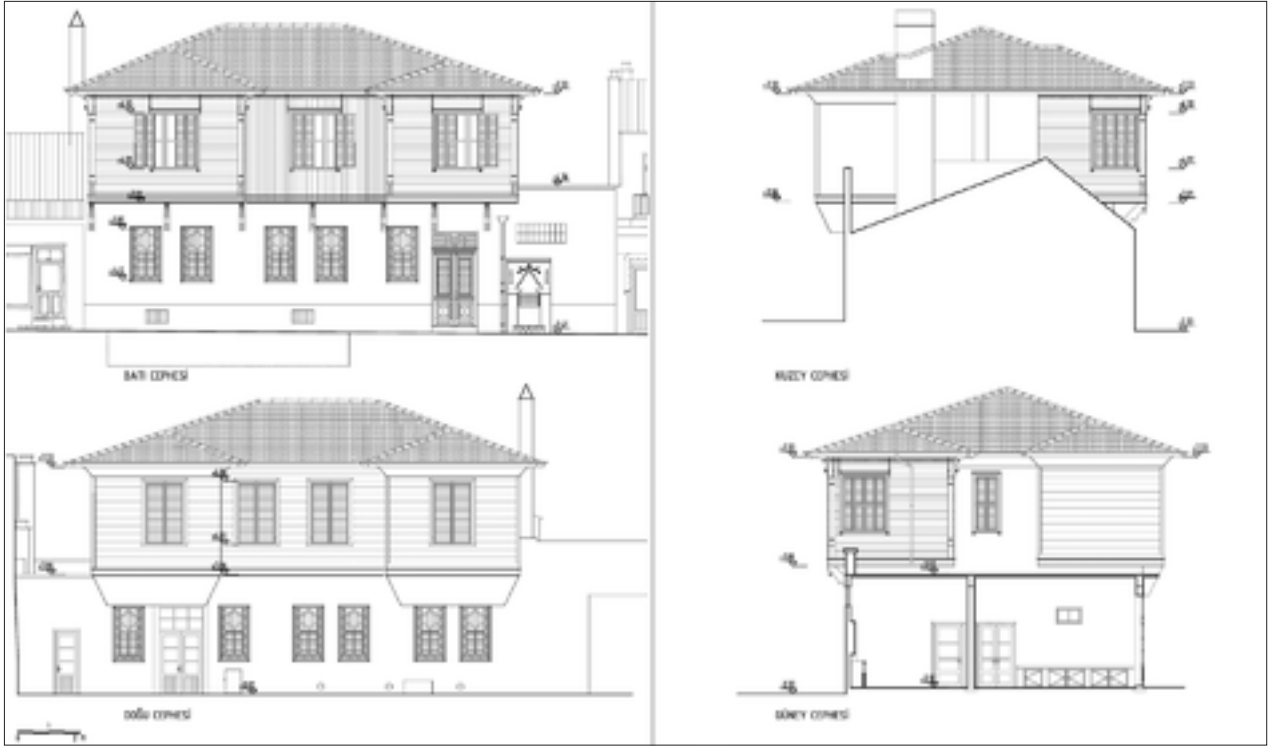
Şekil 12: Birinci dönem restitüsyon ön ve arka cepheler.
