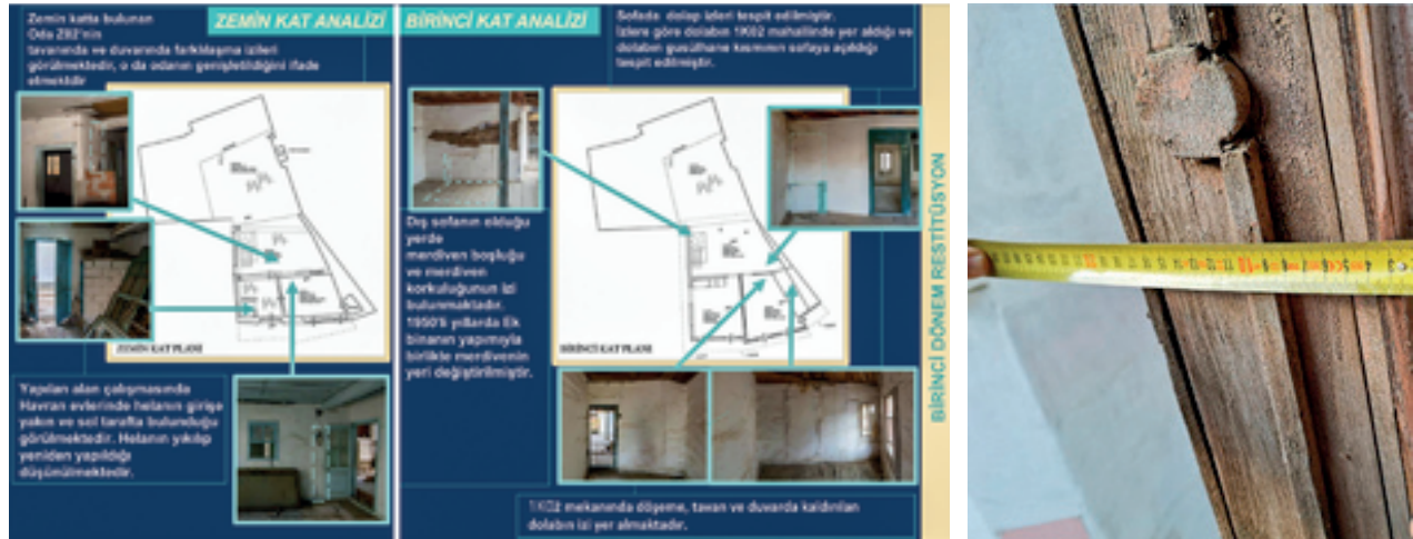
Şekil 13: a) Restitüsyon, birinci dönem güvenilirlik paftası b) Giyotin pencere izi.
