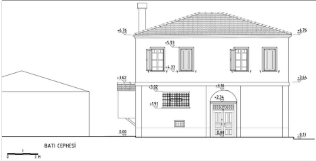
Şekil 17: Restitüsyon, ön cephe - Hastane Cad. görünüşü.
