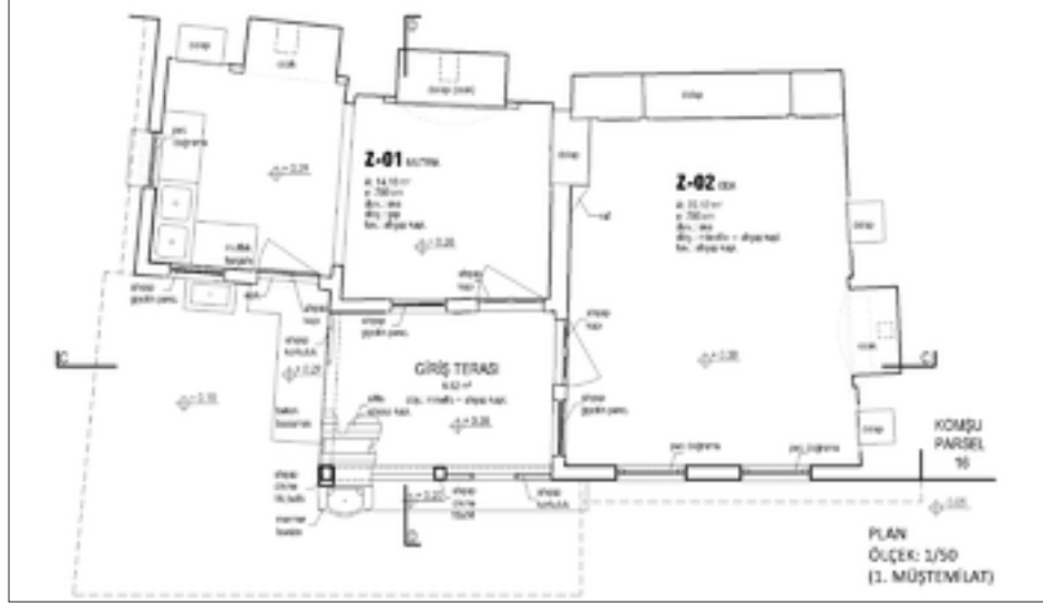
Şekil 18: Birinci müştemilatın planı (rölöve).
