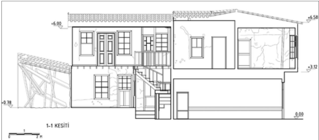
Şekil 8: Rölöve boyuna kesit.
