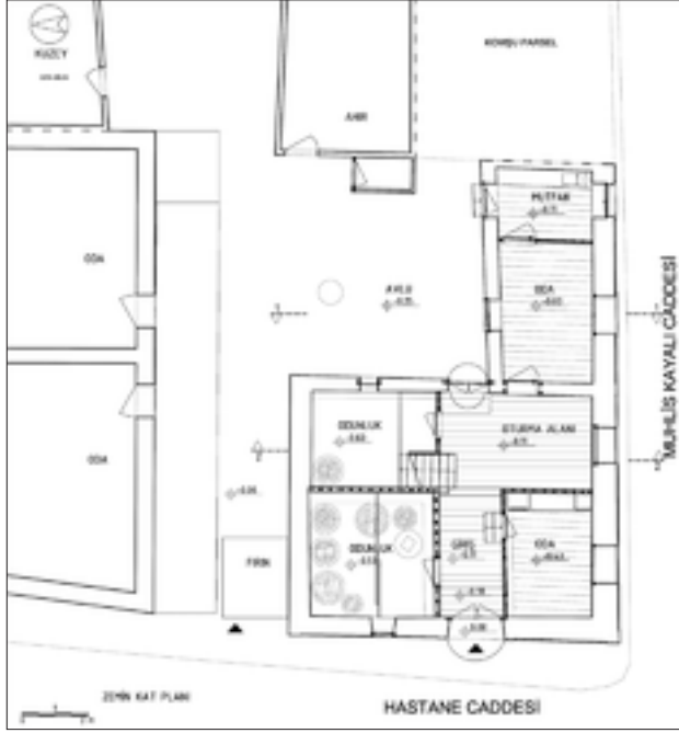
Şekil 12: Restitüsyon kat planları - zemin kat planı.
