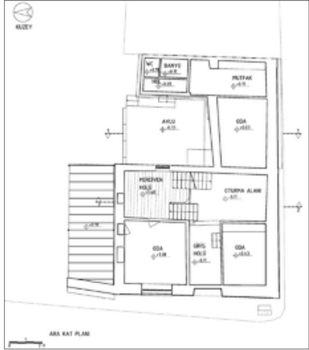
Şekil 6: Rölöve kat planları - ara kat planı.
