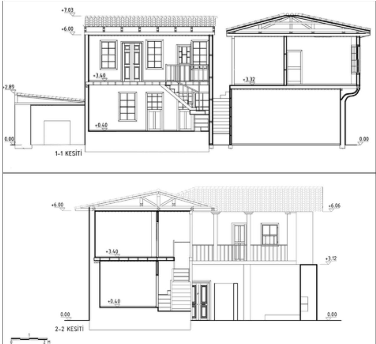
Şekil 15: Restorasyon enine ve boyuna kesit önerisi.
