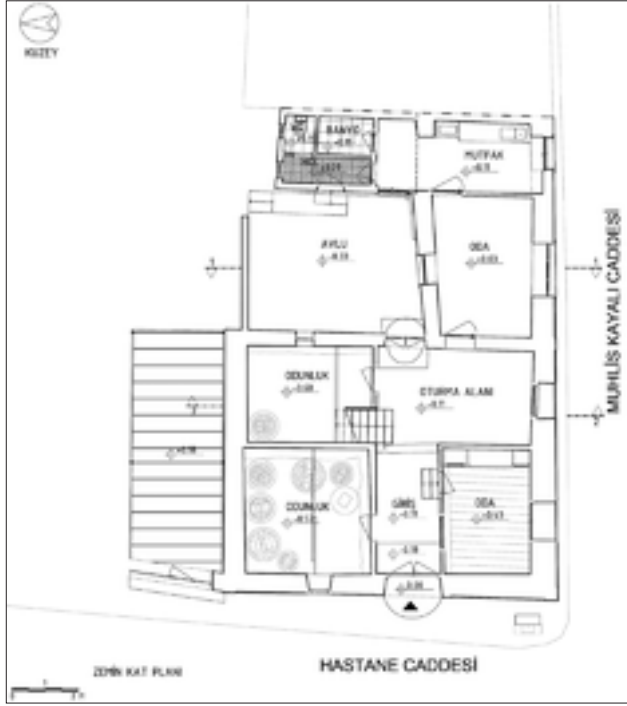
Şekil 5: Rölöve kat planları - zemin kat planı.
