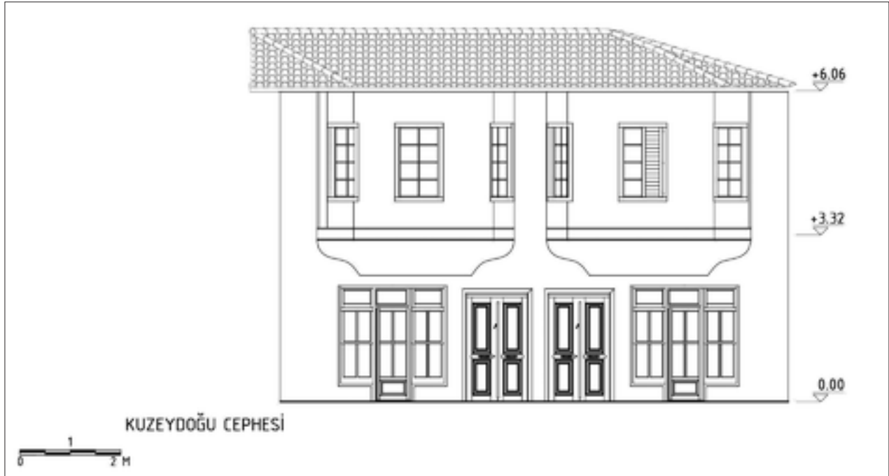
Şekil 16: Ön cephe için restorasyon önerisi.
