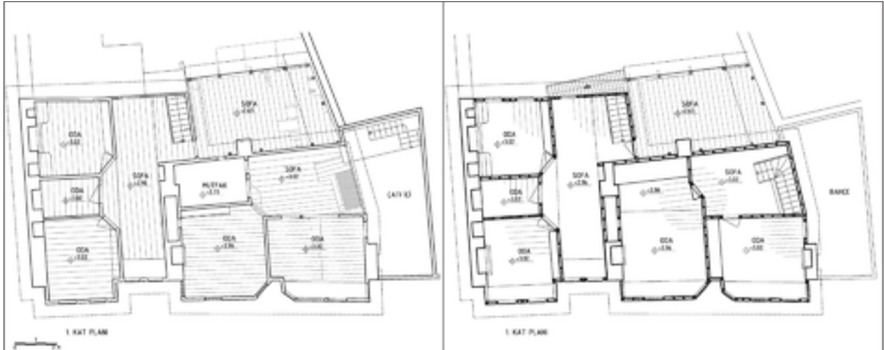
Şekil 9: Üst kat rölövesi (solda) ve birinci dönem restitüsyonu (sağda).
