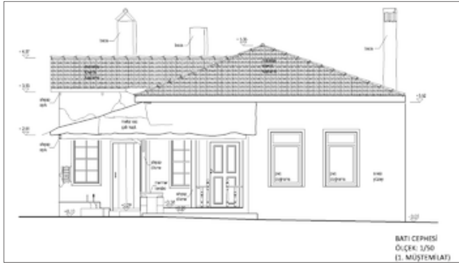
Şekil 19: Birinci müştemilatın batı cephesi (rölöve).
