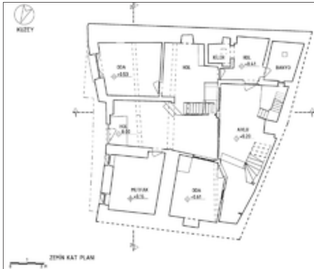
Şekil 3: Rölöve zemin kat planı.
