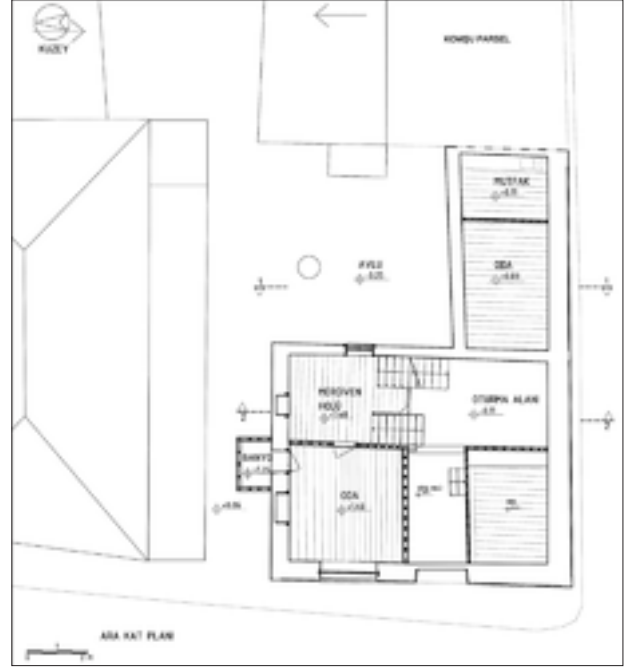
Şekil 13: Restitüsyon kat planları - ara kat planı.
