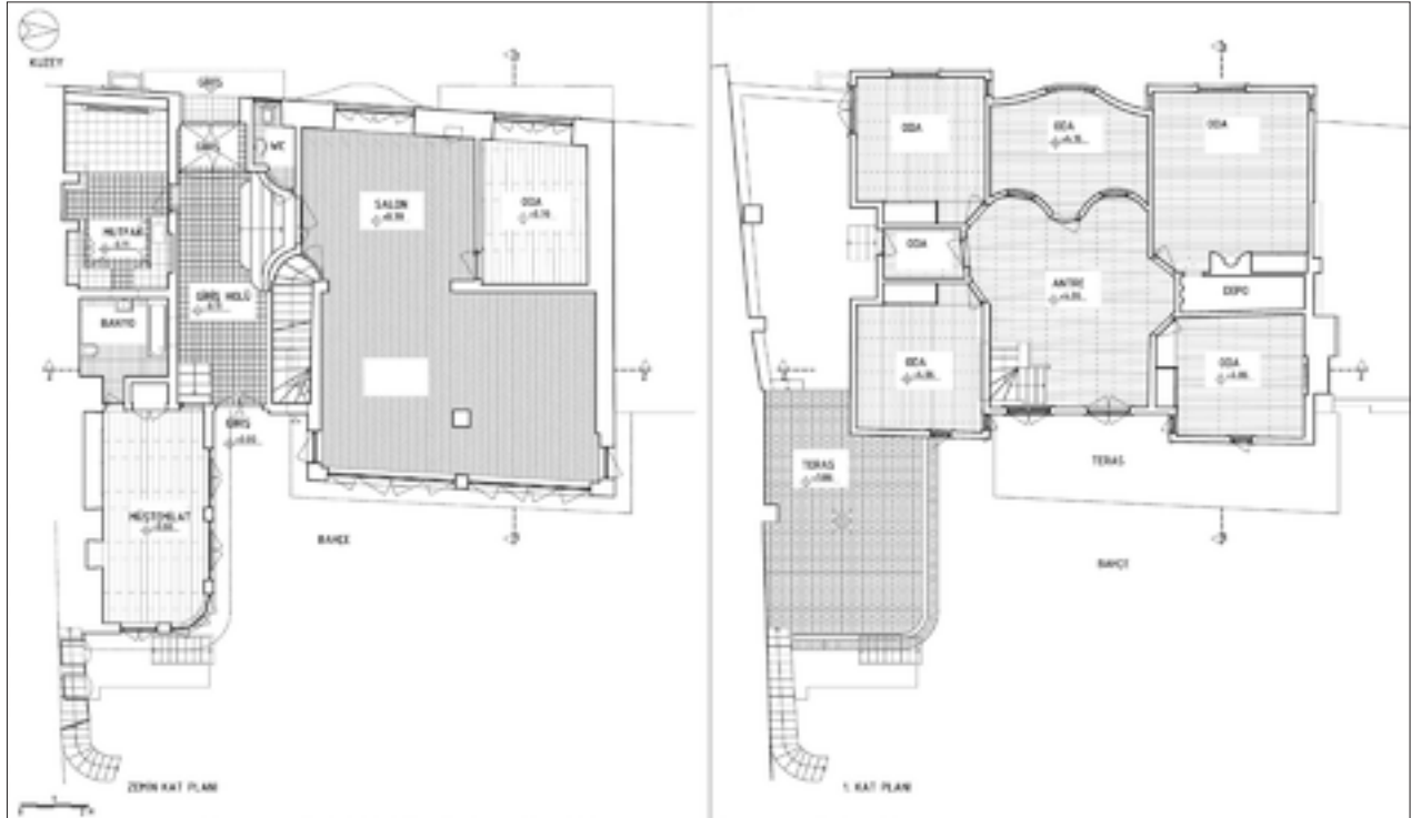
Şekil 6: Rölöve kat planları.
