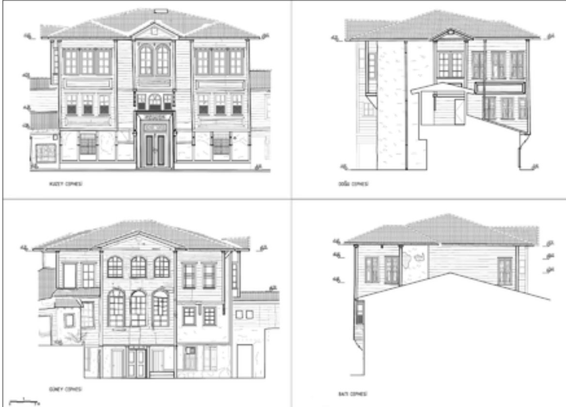
Şekil 11: Kuzey, doğu, güney ve batı cepheleri rölöve çizimleri.
