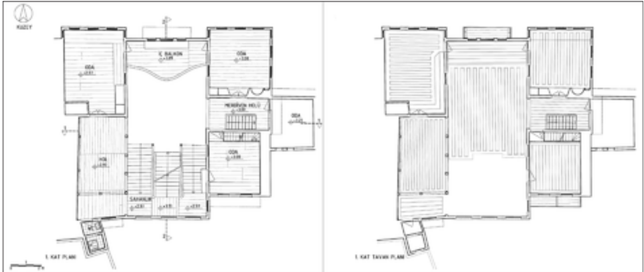
Şekil 5: Birinci kat döşeme ve tavan planları.
